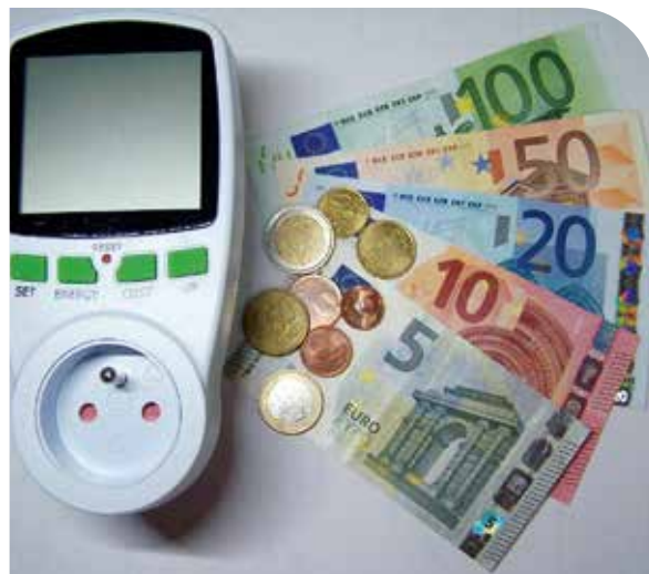
Ein Strommessgerät hilft einen Überblick zu erhalten, welche Geräte auch im Stand-by-Modus Geld verbrauchen.
